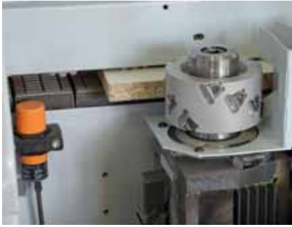
Detail aanzicht van een kantenaanlijm-machine met kettingaanvoer
