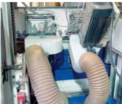
Probleem: machineslijtage door slijtende spanen.
