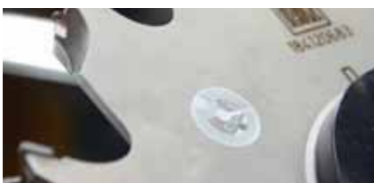
Gereedschap met geïntegreerde datadrager
