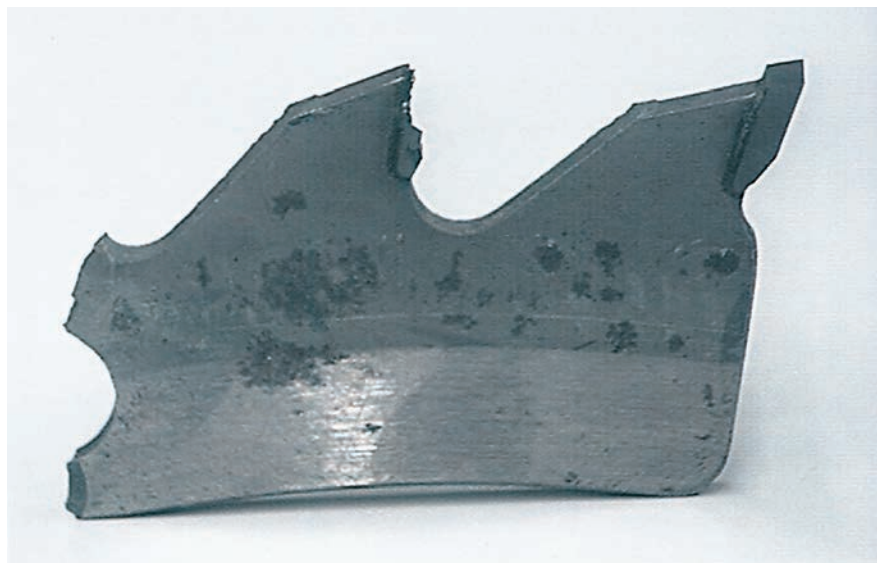
Beschadiging van de zaagtand door overbelasting.
