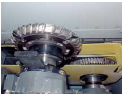
DFC®-verspaners met shreddermessen verkleinen de fineeroverstand op afzuigbare grootte voor een schone afvoer.
