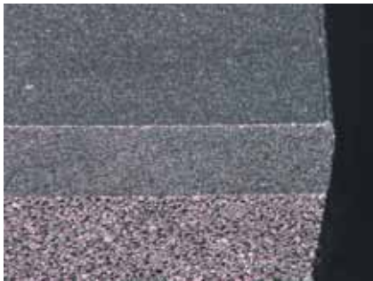
Snede van DP – polykristallijne diamantlaag (boven) opgesinterd op hardmetaal-substraat (onder)
