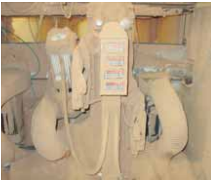
Laminaatbewerking: typische ophoping van spanen in de machine.
