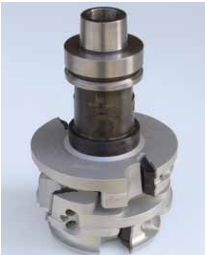
Gereedschapset met HSK-aansluiting voor automatische gereedschapswissel
