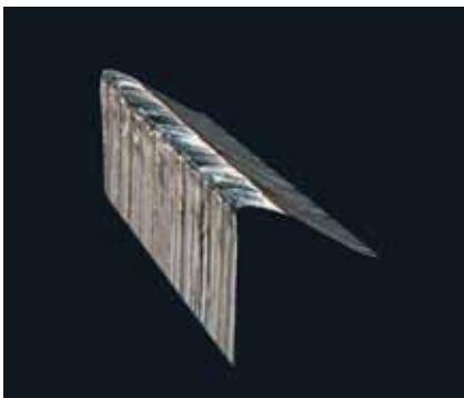
Scherpkantige slijtage van een gecoate HS-sneede
