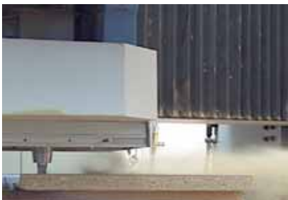
Opdelen van werkplaten met diamant bovenfreesen. Conventionele bovenfrees: spanenstraal treedt horizontaal uit en schiet tegen de borst- of lamellenbescherming.
