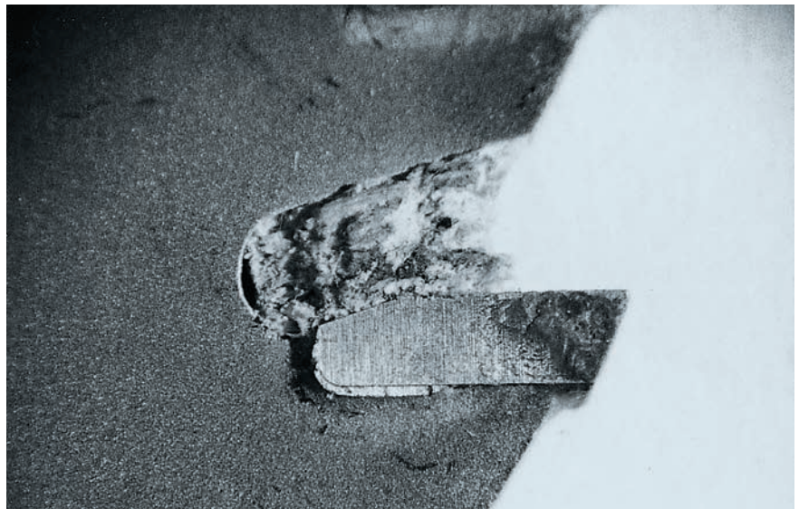
Bourrage dans la zone d'évacuation des copeaux.
