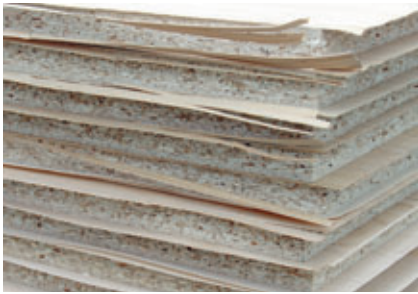
Exemple : déchetage de panneaux plaqués avec dépassement du placage.
