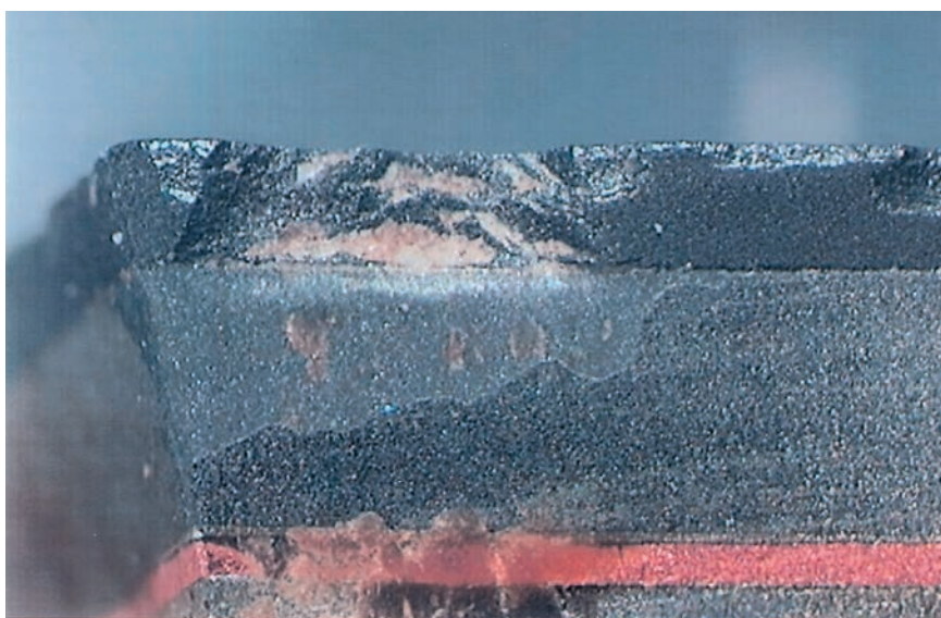
Détérioration de la coupe par des corps étrangers inclus dans la pièce usinée.
