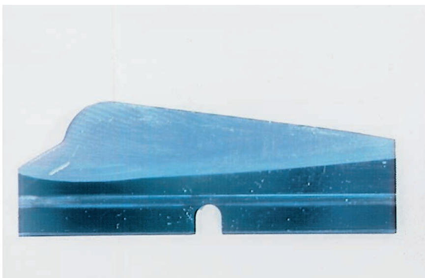
Usure de l'arête tranchante après une mauvaise maintenance.
